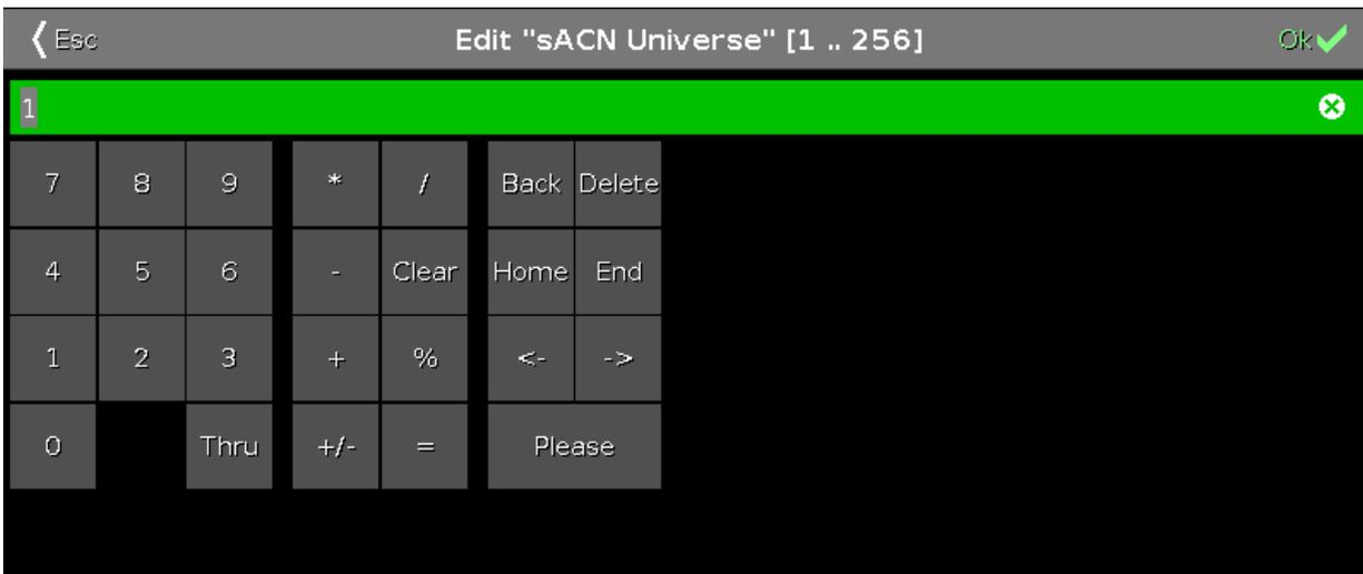
Abbildung 4: Netzwerk Protokolle konfigurieren - Taschenrechner für sACN
